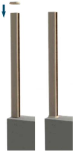
7. Fijar los postes a los soportes (placa base o tubo de empotramiento)
